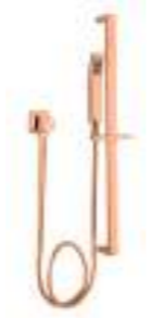
Ref. RB81510 Acabamento rose gold [5091]. Flexível de metal de 1,5 metros. Ducha de barra para box e banheira com regulagem. Vazão: 8 l/min com 15 m.c.a. Pressão recomendada: de 15 m.c.a. até 40 m.c.a.
