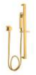
Ref. RB71510 Acabamento dourado [5090]. Flexível de metal de 1,5 metros. Ducha de barra para box e banheira com regulagem. Vazão: 8 l/min com 15 m.c.a. Pressão recomendada: de 15 m.c.a. até 40 m.c.a.
