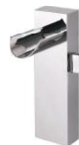
Ref. 8402C. Misturador com cartucho progressivo para lavatório. Tipo cascata. Bica alta, indicada para cuba de apoio. Acabamento cromado. Vazão: 6 l/min, com 8 m.c.a. Acompanha ligação de flexível de 50 cm. Diâmetro do furo para instalação: \varnothing 3,5 cm. Pressão recomendada: 8 m.c.a. até 10 m.c.a.
