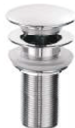
Ref. RB133. Válvula clic-clac com acionamento direto. Acabamento cromado. Rosca de 7/8". Diâmetro rosca: ø 3 cm.
