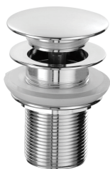
Ref. RB1133. Válvula clic-clac com acionamento direto. Acabamento cromado. Rosca de 1 1/4". Diâmetro rosca: ø 4 cm.
