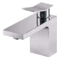
Ref. RB9057. Misturador monocomando para lavatório. Acabamento cromado. Vazão: 6,5 l/min, com 4 m.c.a. Acompanha ligação de flexível de 50 cm. Diâmetro do furo para instalação: \varnothing 3,5 cm. Pressão recomendada: 4 m.c.a. até 40 m.c.a.
