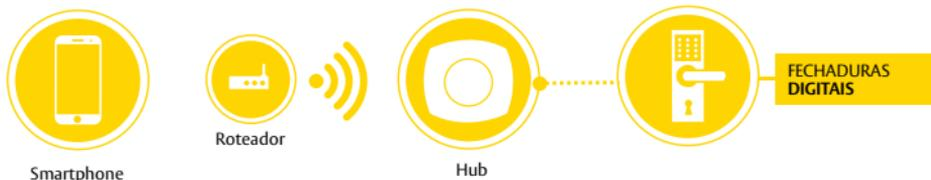
É necessário adquirir o módulo de comunicação Zigbee de acordo com o modelo de fechadura escolhido!
