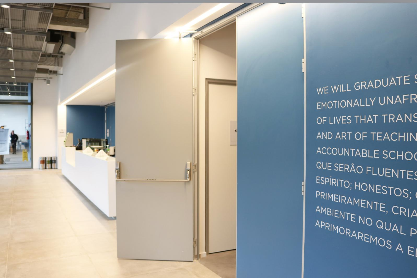
A barra antipânico Metalika garante a saída de pessoas do ambiente a qualquer momento, com o mínimo de esforço físico, independente do uso de chave ou qualquer outro objeto, permitindo dessa forma, uma evacuação rápida do ambiente em casos de emergência.
