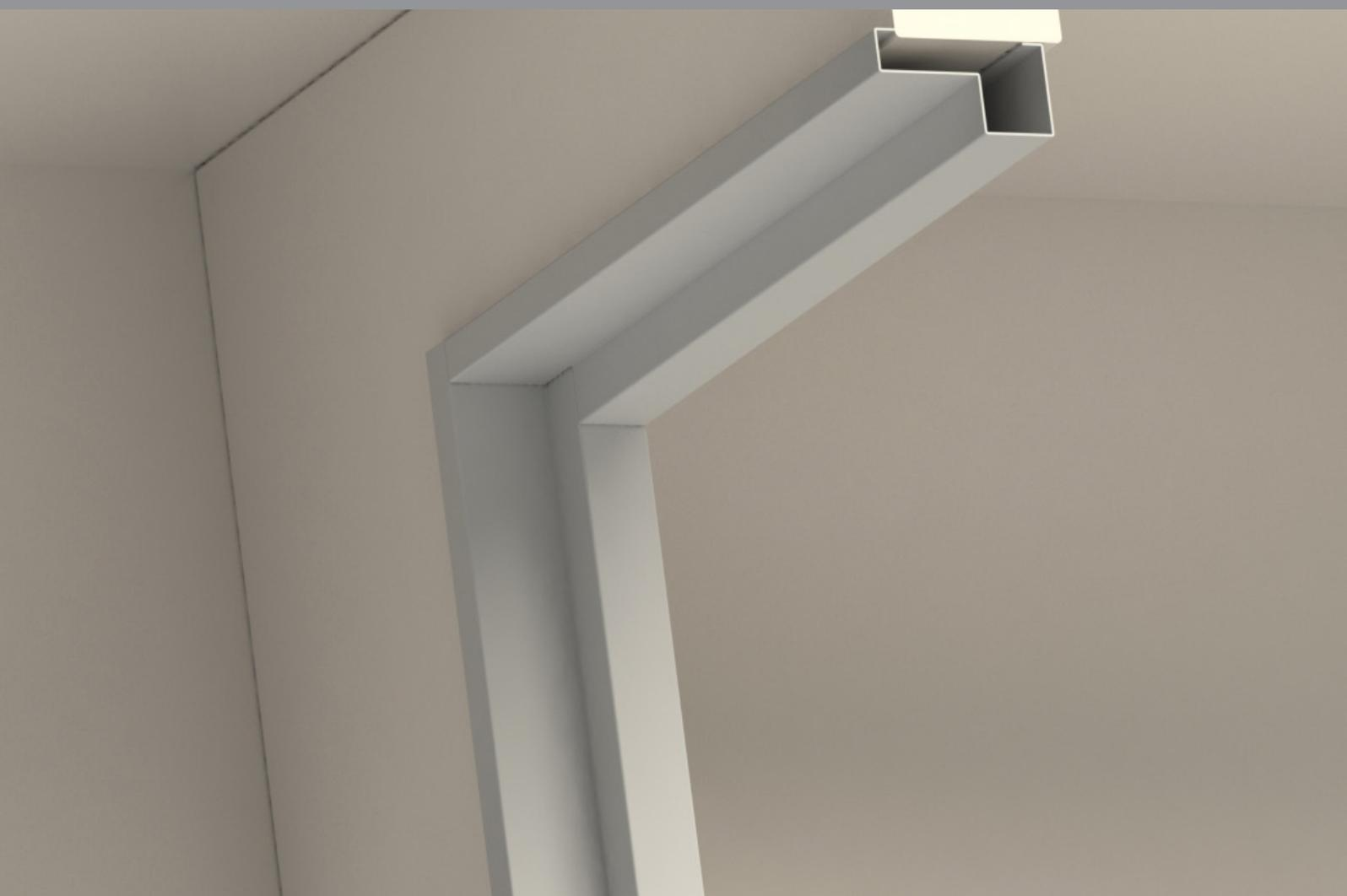
Batentes especialmente desenvolvidos para aplicação em portas corta-fogo Metalika. Os Batentes são confeccionados em chapa de aço galvanizado nº 18 (1,25mm), podendo ser fornecidos com pintura ou revestimento em inox.
