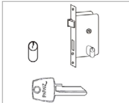
Fechadura externa com cilindro normal
